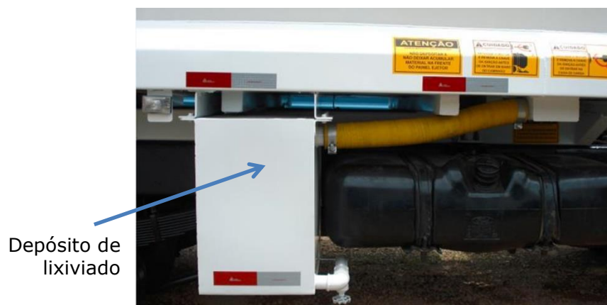
Depósito de lixiviado de la caja
