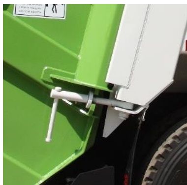
Compuerta de cola trabada
